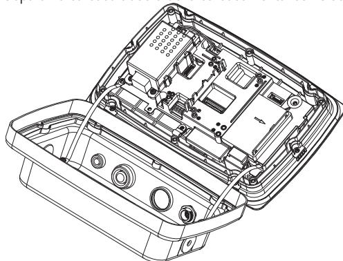
3. Conectar el cable al conector 2 de la placa principal. Colocar la ferrita en la ranura de la parte negra, como se muestra.
