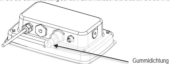
9. Befestigen Sie die Überwurfmutter der M25-Verschraubung.
