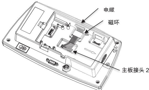
4. 安装电路板。用 2 颗螺丝固定。连接 12 针电缆接头到电路板 12 针接头。
