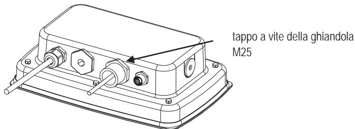
9. Svergolare la tenuta stagna in gomma nel Cavo di uscita del loop corrente e spingerlo nel foro.
