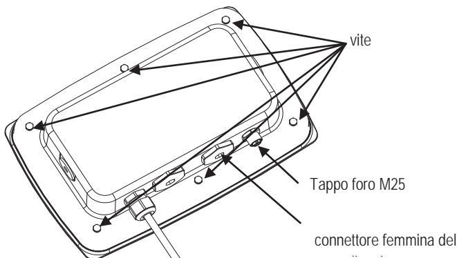
2. Abbassare l'alloggiamento posteriore dall'alloggiamento anteriore, come mostrato.
