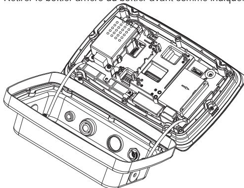
3. Connecter le câble au connecteur 2 du tableau principal. Placer la ferrite dans la fente du boîtier arrière comme indiqué.
