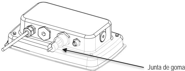
9. Fijar la tuerca ciega del prensaestopas M25.
