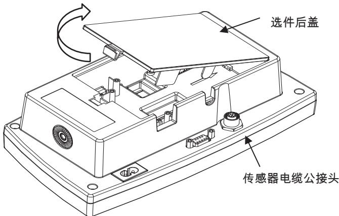
2. 断开下图选件后盖的挡边。
