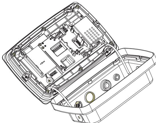
3. Schließen Sie das Kabel an den Hauptplatinenanschluss 2 an.
