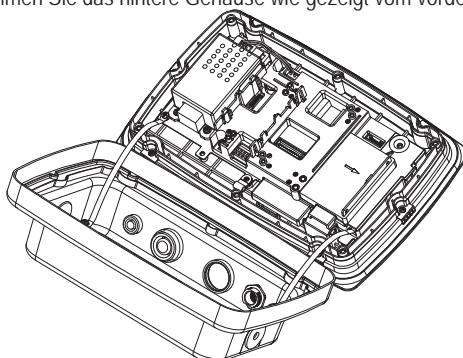
3. Verbinden Sie das Kabel mit dem Hauptplatinenanschluss 2. Setzen Sie den Ferrit wie gezeigt in den Schlitz des schwarzen Teils.
