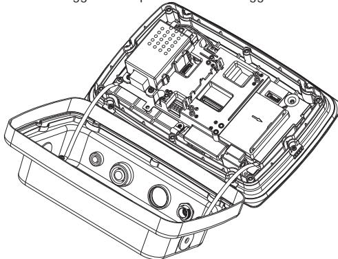
3. Collegare il cavo al connettore 2 del pannello principale. Porre la ferrite nella scanalatura della parte in nero, come mostrato.
