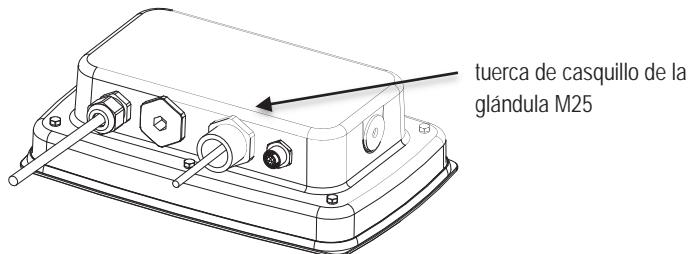
8. Colocar la junta de goma en el cable Ethernet e introducirlo en el orificio.
