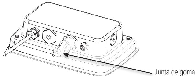
Para el TD52XW con cubierta trasera invertida:
