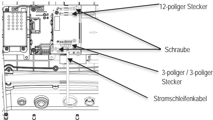
7. Setzen Sie das hintere Gehäuse wieder auf das vordere Gehäuse. Bringen Sie die 6 Schrauben wieder an.
