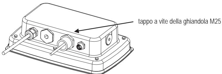
8. Svergolare la tenuta stagna in gomma nel cavo Ethernet e spingerlo nel foro.
