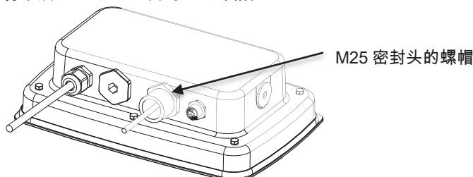
8. 将橡胶密封垫圈弯曲，塞入以太网电缆的孔中。
