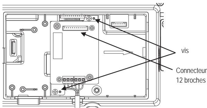
5. Connecter le câble de circuit aux 3 broches et aux connecteurs à 3 broches.
