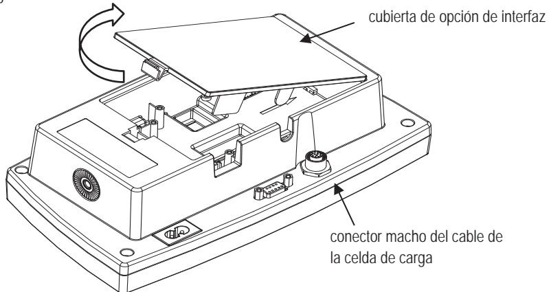
2. Cortar la lengüeta de la cubierta de la interfaz, como se muestra.
