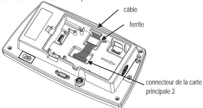
4. Installer le tableau du courant de circuit. Sécuriser avec 2 vis. Connecter le câble au tableau du câble de circuit actuel à 12 broches.
