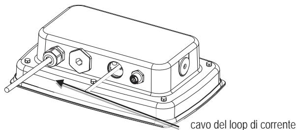
8. Fissare il coperchio a dado del passacavo M25 nell'alloggiamento posteriore.
