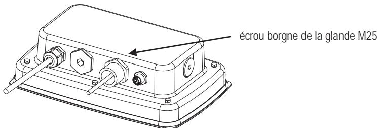
8. Enrouler le joint en caoutchouc sur le câble Ethernet et pousser dans le trou.
