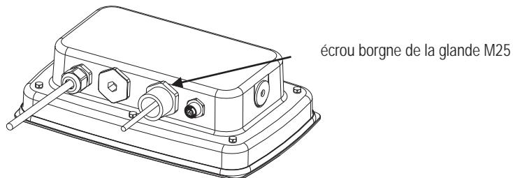
9. Enrouler le joint en caoutchouc sur le Câble de sortie de boucle de courant et pousser dans le trou.
