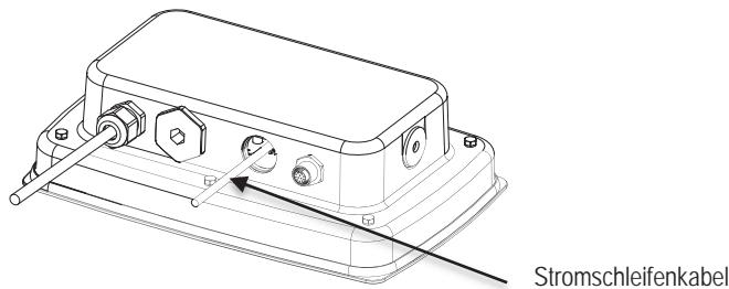
8. Ziehen Sie die Überwurfmutter der M25 Verschraubung am hinteren Gehäuse fest.
