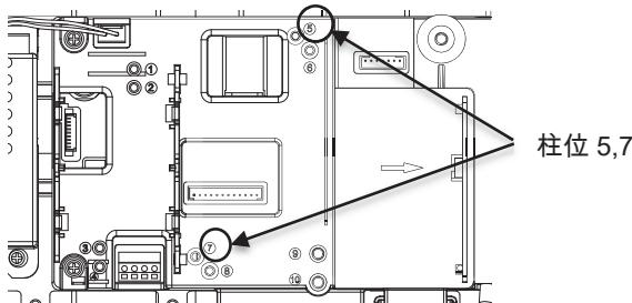
6. 将电路板导线穿过 M25 插孔。连接导线到 3 针和 3 针接头。
