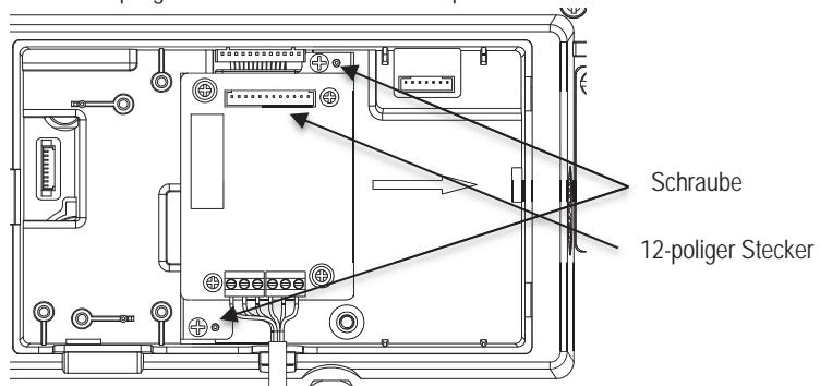
5. Schließen Sie das Stromschleifenkabel an die 3-poligen und 3-poligen Steckverbinder an.
