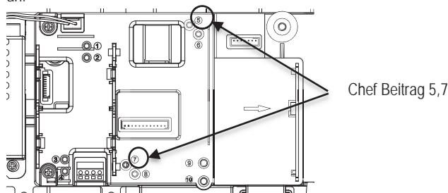
6. Stecken Sie das Stromschleifenkabel durch das M25-Loch. Schließen Sie es an den 3-poligen und 3-poligen Stecker an.
