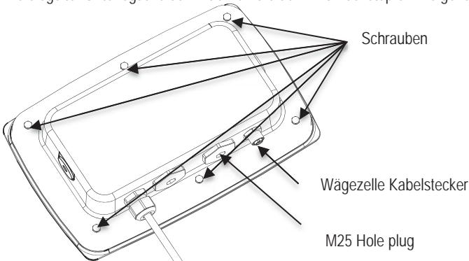
2. Nehmen Sie das hintere Gehäuse wie gezeigt vom vorderen Gehäuse herunter.
