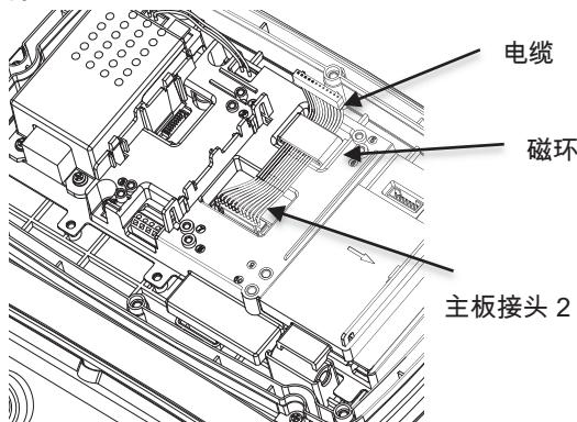
4. 拧松螺帽，拆下电缆密封接头，移除橡胶密封垫圈。将继电器输出线穿过螺帽，然后将橡胶密封垫圈平放在电缆上。将电缆穿过密封接头。
