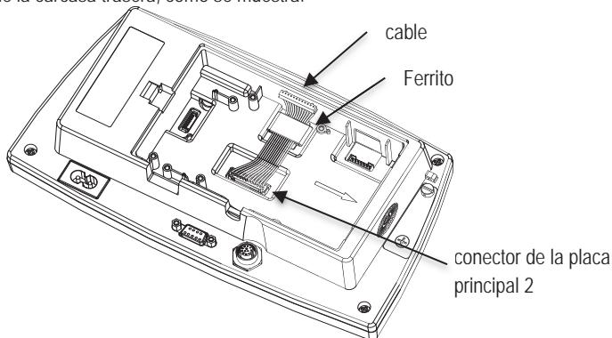
4. Instalar la placa de bucle de corriente. Fijarla por mediación de los 2 tornillos. Conectar el cable al conector de 12 pines de la placa de bucle de corriente.
