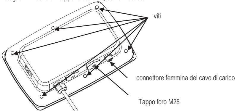
2. Abbassare l'alloggiamento posteriore dall'alloggiamento anteriore, come mostrato.
