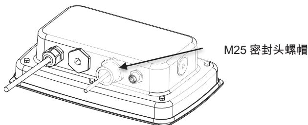
9. 将橡胶密封垫圈弯曲，塞入电路输出导线的孔中。
