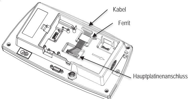
4. Installieren Sie die aktuelle Loopplatine. Sichern Sie sie mit 2 Schrauben. Schließen Sie das Kabel an den 12-poligen Stecker der Stromschleifenplatine an.
