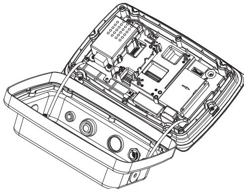
3. 将 12 针电缆接头连接到主板接头 2。如图所示，将磁环放入黑色部分的卡槽内。
